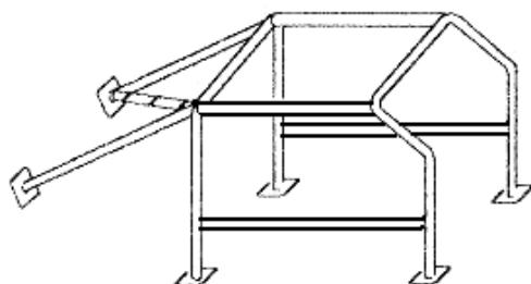
Jsou povoleny tyto minimální rozměry ocelových bezešvých trubek **ø38 x 2,5; ø40 x 2,5, ø45 x 2,5 a ø50 x 2,0 mm**. Kombinace průměrů je povolena.
